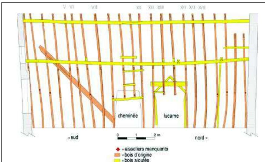
Fig. 8 - Bruges, 4, Kraanplein, coupe longitudinale avec numérotation des chevrons (dessin V. Debonne)
